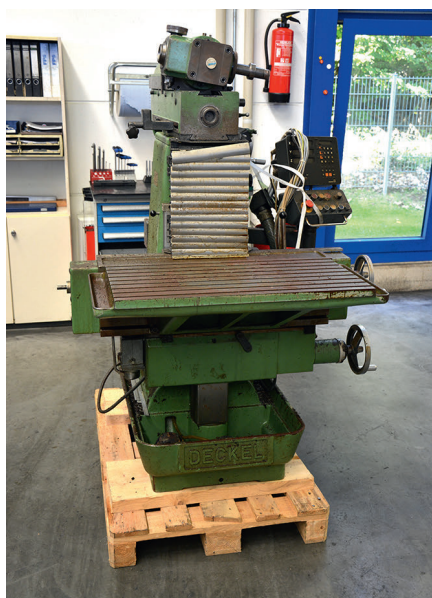
3 Generalüberholung und Modernisierung von Deckel-FP-Maschinen tragen bei FPS immer noch 50 Prozent zum Umsatz bei. Die sechswöchigen Arbeiten beinhalten auch das manuelle Schaben der Flachführungen, eine nur noch selten anzutreffende Handfertigkeit; 300 Retrofit-Maschinen stehen auf Lager © Hanser
