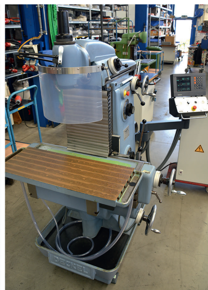
3 Generalüberholung und Modernisierung von Deckel-FP-Maschinen tragen bei FPS immer noch 50 Prozent zum Umsatz bei. Die sechswöchigen Arbeiten beinhalten auch das manuelle Schaben der Flachführungen, eine nur noch selten anzutreffende Handfertigkeit; 300 Retrofit-Maschinen stehen auf Lager © Hanser
